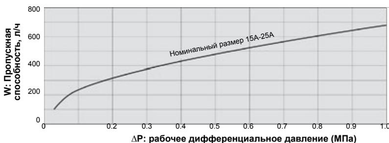
· Пропускная способность, указанная на графике выше, является максимальным значением. При проектировании системы выберите конденсатоотводчик с достаточным запасом прочности (более чем в четыре-пять раз превышающим обычный уровень). То есть, например, если требуется пропускная способность 100 кг/ч, то выберите конденсатоотводчик, способный разгружать от 400 до 500 кг/ч.
